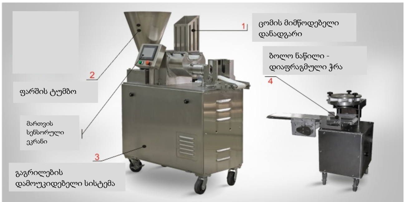
პელმენების დამამზადებელი ავტომატური დანადგარი გამყინავი სისტემით სურ.11
