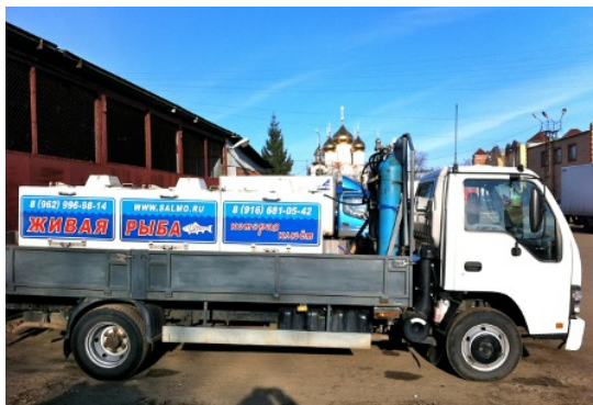
ცოცხალი თევზის გადასაზიდ ავტოტრანსპორტზე დამაგრებული ჟანგბადის ბალონები სურ.2
