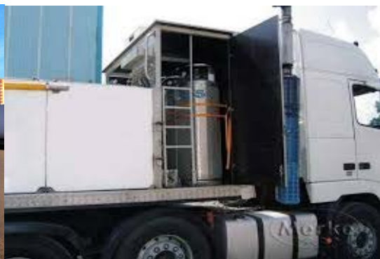
ცოცხალი თევზის გადასაზიდ ავტოტრანსპორტზე დამაგრებული ჟანგბადის ბალონები სურ.2
